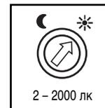
Плавно регулируемый порог срабатывания сенсора 2 – 2000 лк.
