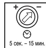
Время освещения может быть плавно установлено в диапазоне от 5 сек. до 15 мин.
