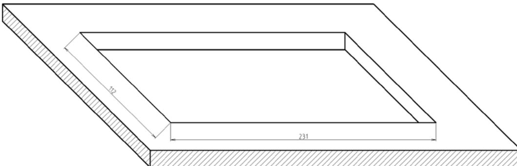
2. Установить монтажную коробку в отверстие и зафиксировать её, используя крепежный комплект.
